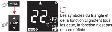
2. Entrez dans le réglage CHEMINÉE en appuyant sur la touche MENU. L'icône du triangle devient fixe et la fonction de réglage se met à clignoter.
